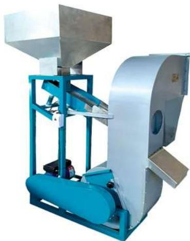
مدل دوم دستگاه های بوخاری، سرند بوسیله فشار مثبت یا مکش هواست که جهت محصولات ریز دانه و یا اغلب به منظور تمیز کردن خاک و پوکه گیری از محصول استفاده می شود.
