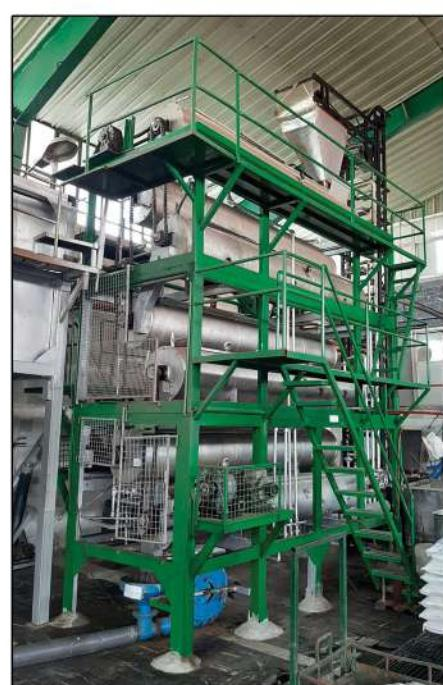
دستگاه های تفت دو جداره در دو مدل گهواره ای با ظرفیت ۱۲۰ کیلوگرم و مدل طبقاتی با جریان محصول پیوسته تا ظرفیت ۷۰۰ کیلوگرم در ساعت تولید می گردد.
