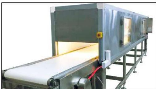
این دستگاه یک نوار کشنه محصول با طول و عرض مورد نیاز جهت سرمایش دارای محفظه سردخانه با پنل دو جداره (دارای یونیت کمپرسور و کندانسور) با دمای قابل تنظیم وسیstem دیفراس است اوپراتور ها می باشد.
