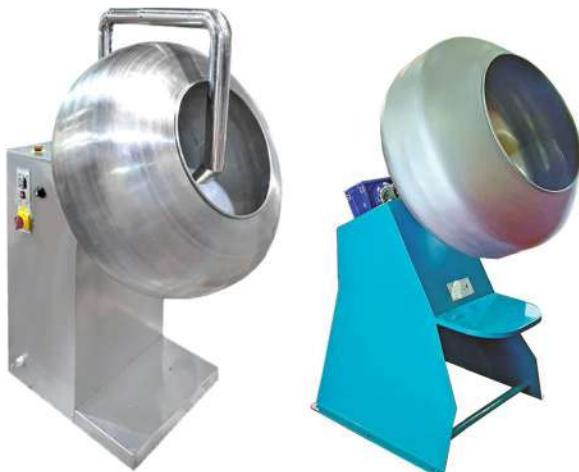
این دستگاه جهت درازه کردن یا روکش نمودن به اسماز تیزها، شکلات های سنگی و مغزهای خوراکی و ... بکار می رود. همچنین از آن جهت طعم دار نمودن دانه های روغنی استفاده می شود. این دستگاه دارای سیستم هوادهی سرد و گرم می باشد. همچنین میتوان به آن قابلیت تنظیم سرعت و یا تخلیه خودکار را اضافه نمود.
