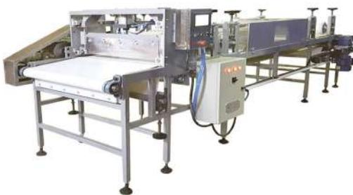
با استفاده از این دستگاه تولید انواع اسنک ها با قابلیت تنظیم برش طولی محصول و قابلیت اضافه شدن شوکوبار روی نوار ممکن است.
