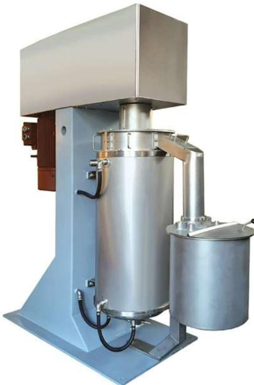
بالمیل های با جریان تولید ممتد، جهت تولید شکلات و یا کاهش دانه بندی خمیر دانه های روغنی مورد استفاده قرار می گیرند. هنگام استفاده از این مدل نیاز به یک مخزن میکسردار مایعات ابتدایی، جهت فرمولاسیون می باشد.
