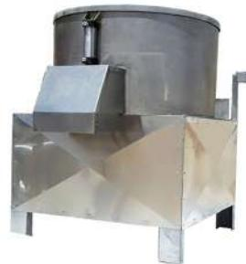
پوست کنی کنجد به دو روش سنتی (البته به صورت مکانیزه) و صنعتی صورت می‌پذیرد. ظرفیت : ۲۰۰ الی ۹۰۰ کیلوگرم در ساعت
