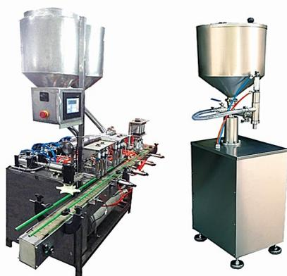
این دستگاه در مدل‌های تک نازل و چند نازل بصورت پدالی یا اتومات ساخته می‌شود و توانایی پر نمودن انواع ظروف پت، بطری و شیشه، در هر ظرفیتی را داراست.
