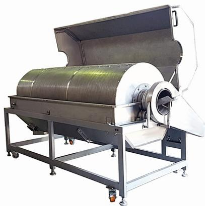
از این دستگاه در صنایع کنسرو سازی جهت تولید کنسرو نخودفرنگی، هویج، ذرت و ... و همچنین در عملیات پیش از پوستکنی از دانه های روغنی جهت تهیه پرک و خلال استفاده میشود.
