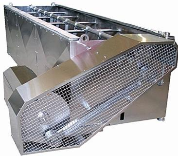
دستگاه های تفت دو جداره در دو مدل گهواره ای با ظرفیت ۱۲۰ کیلوگرم و مدل طبقاتی با جریان محصول پیوسته تا ظرفیت ۷۰۰ کیلوگرم در ساعت تولید می گردد.
