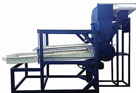
این دستگاه شامل دو تا سه مشبندی متفاوت و همچنین سیستم دمش هوا برای جداسازی پوست و ذرات سبکتر می باشد.
