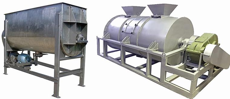
رِیْبون بلنדרها در سایزهای متفاوت بصورت تک جداره و دو جداره، بمنظور مخلوط کردن چند نوع پودر و یا فاز پودری با اسانس بکار میروند.
